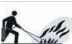
3. Löschen Sie durch mehrmaliges Drücken des Hebels. Entleeren Sie den Feuerlöscher nicht auf einmal.
