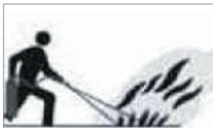
3. Slukk ved å klemme sammen utløseren flere ganger. Ikke tøm hele brannslukningsapparatet på en gang.
