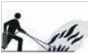
3. Sluk ved at trykke på håndtaget nogle gange. Tøm ikke brandslukkeren på én gang.
