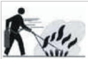
2. Löschen Sie eine brennende Oberfläche von vorne nach hinten.
