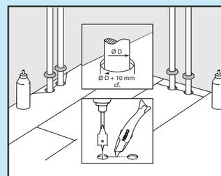
Bruk deretter et egnet lim langs skjærekantene på stykket du skar ut og lim stykket på plass. Sørg for at det ikke kommer lim mellom utskjæringen og undergulvet
