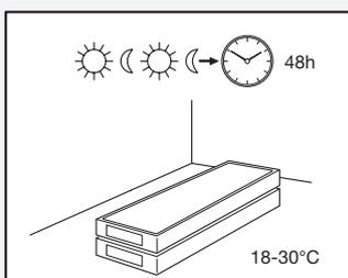
Monter gulvet ved en rom- og gulvtemperatur på mellom 18 og 30 °C.
