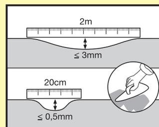
Fuktighetsinnholdet i undergulvet må være mindre enn 2,5 % CM / 75 % RH (betongpuss) eller mindre enn 0,5 % CM / 50 % RH (undergulv av anhydritt). Hvis gulvet er oppvarmet, må resultatene være henholdsvis 1,5 % CM / 60 % RH og 0,3 % CM / 40 % RH. Fuktigheten må alltid måles, og resultatene av målingen må registreres og oppbevares.
