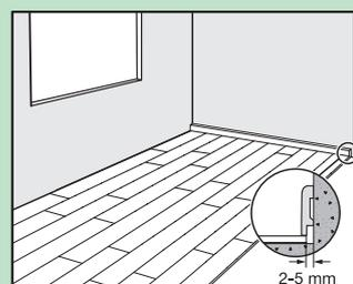
Gulvet må aldri blokkeres. Hvis det står tunge/fastmonterte gjenstander (f.eks. kjøkken, kjøkkenøy, innebygde skap, tunge ovner) på gulvet, fungerer de som en vegg, slik at minimum ekspansjon kan forventes der. Flytende installasjon skal forbli flytende! Hvis dette ikke er mulig, må du bruke limt Pergo vinyl.
