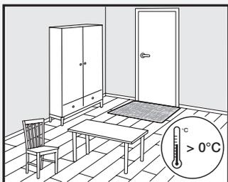
Sørg for at innendørstemperaturen alltid holdes over 0 °C og fortrinnsvis mellom 18 og 30 °C. Du må bruke SunSafe-underlag hvis gulvtemperaturen blir over 45 °C.
