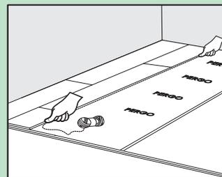
Adskilte rom med og uten gulvvarme, eller med forskjellige termostater, eller f.eks. korridor mot kjøkken, bør monteres med en overgangsprofil og en ekspansjonsåpning på minst 5 mm.
