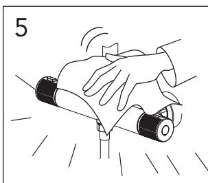
Rengjør jevnlig dysene på både hodedusj og hånddusj for å forhindre at kalk blokkerer dysene og forårsaker sprekker i dusjhodene.
