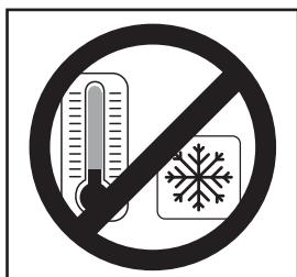
Driftstemperaturen i miljøet bør være over 4 °C. Hvis den er under 4 °C, kan produktet oppleve deformasjon, frostskader og andre skader.
