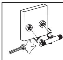
Når du strammer med en skiftenøkkel, er det viktig å beskytte produktets overflate med en myk klut for å unngå riper og at maling skaller av på grunn av direkte kontakt med skiftenøkkelen.
