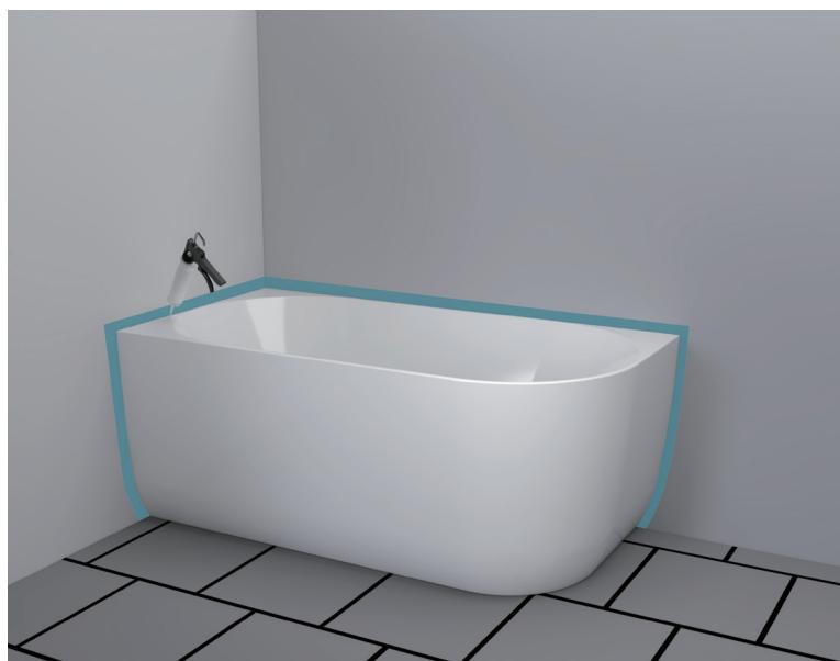
**NO** – Påfør silikon på veggen for å sikre stabilitet
