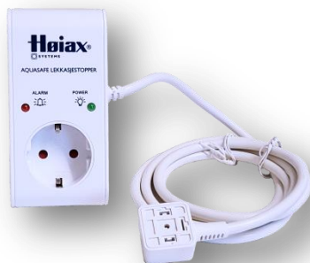
Lekkasjestopper med strømcutt Lekkasjestopperen registrerer signal fra sensortapen og forsyner magnetventilen med strøm. Den har eget strømuttak som automatisk kutter strømmen ved en eventuell lekkasje. Maks belastning i strømstikket er 2300W. Ved elektrisk tilkobling av varmtvannsberedere skal NEK 400 følges.
